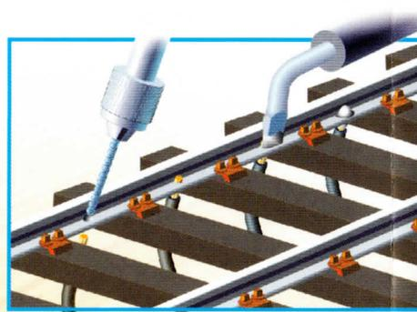
empfohlene Arbeitsschritte zur Herstellung sicherer Einspeisungs-Lötungen im Fuß der Om-Schienenprofile. Bohrungen möglichst mittig in den Schwellenzwischenraum setzen, um der Gefahr hitzebedingter Verformung des Kunststoffs vorzubeugen. Lötungen auf der vom Betrachter abgewandten Seite des Schienenprofils vorsehen. Zinnkegel nachträglich ggf. für den freien Durchgang von Radlaufkränzen flachschleifen
